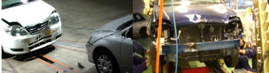
フレーム修正作業
