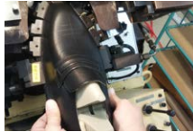
底付け作業の様子(機械釣り)
