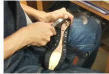
底付け作業の様子(手釣り)
