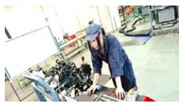
エンジン故障原因探求作業の様子
