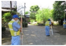
水準測量 (高低差の観測)
