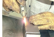
レーザー溶接作業
