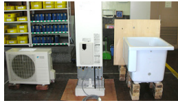
給湯機（エコキュートシステム）
