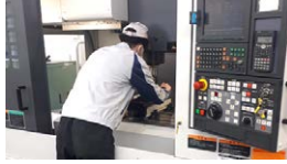
NC工作機械を使った加工実習
