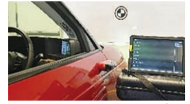
電子制御装置整備作業(エーミング)
