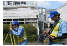
電子平板 (現況平面図作成のための細部測量)
