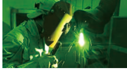
アーク溶接作業
